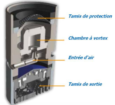
Vue en coupe d'un vortexeur ECO
